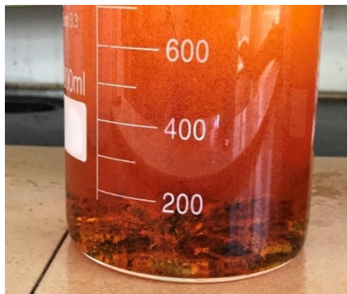
Figure 2. The leaching process of PCBs using aqua regia solution
